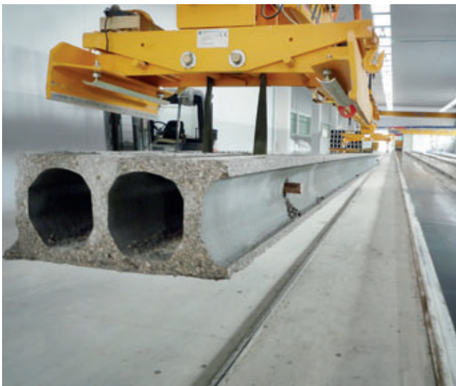
Extracción de una placa alveolar de la pista de producción mediante travesaño elevador.
