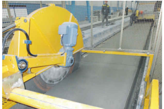
Corte en dirección longitudinal de una placa alveolar recién hormigonada con la sierra de hormigón fresco Nordimpianti.
