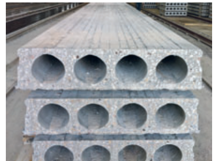
Una placa alveolar producida con la extrusora Nordimpianti con una anchura de 900 mm.
